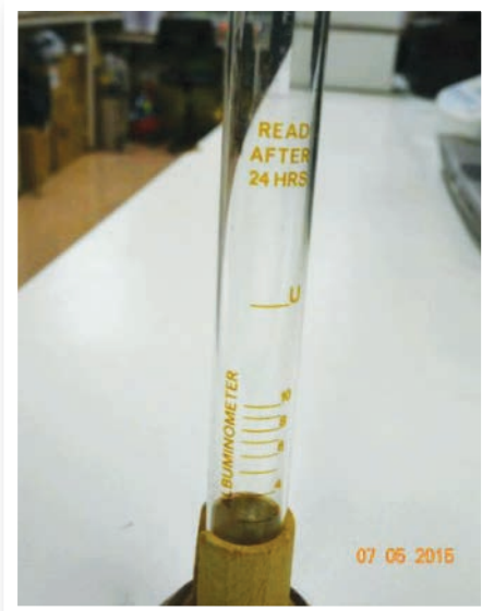
▲這不是一般的試管，究竟是什麼呢？圖中所示的是白蛋白計(Albuminometer)，白蛋白是一種蛋白質，在體內含量過高或過低亦不合適。很多年前，若白蛋白測試以尿液為標本，會利用此儀器測試出尿蛋白的含量，從而得知腎臟有否出現問題。（相片由龍福昌先生提供）
