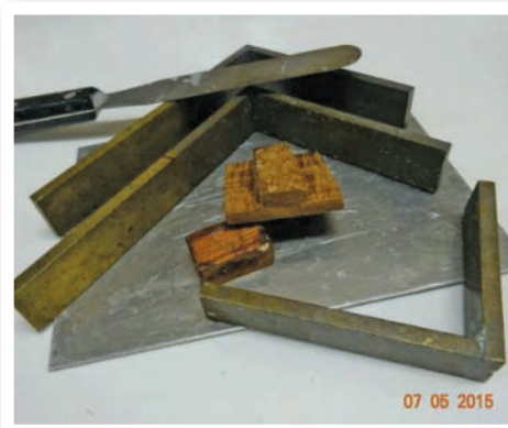
▲知不知道圖中的是什麼？你所見的是L型倒模，在初期的組織病理學實驗室，化驗人員會在L型倒模注入蠟製造出矩形器皿，用以盛載已處理的組織切片，並放置標籤在旁以助辨認不同樣本。缺點是容易將樣本混淆，所以現時已經淘汰此做法了。（相片由龍福昌先生提供）
